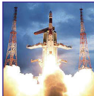
Сл. III.28. При полетувањето на ракетите во реакција со керозинот се трошат околу 1400 тони течен кислород.
