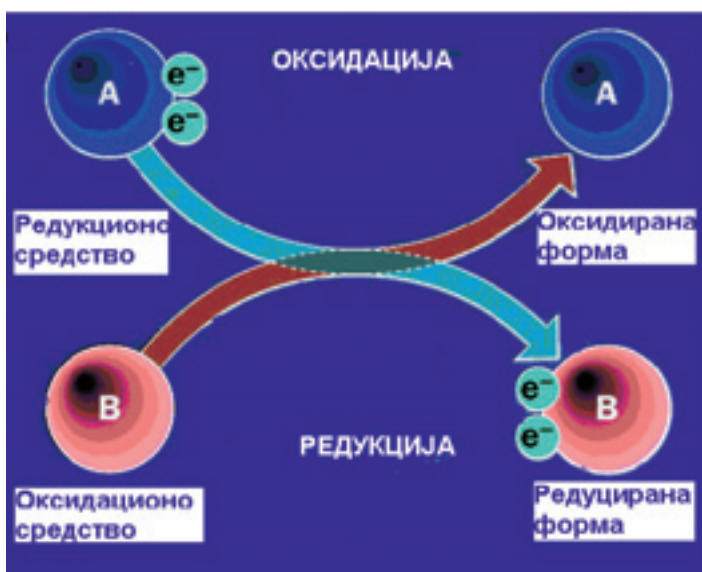
Сл.1.3. Шематски приказ на редокс-реакција. Супстанцата А предава електрони на супстанцата В и притоа ја редуцира, а самата се оксидира.
