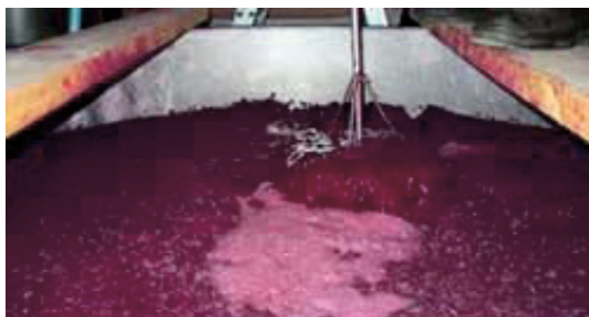
Сл. V..2. Изгмеченото грозја ферментира на температура од 10-18 °C, при што се ослободува \text{CO}_2 .
