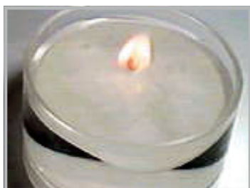
Сл.III.7. Калиумот бурно реагира со водата при што се ослободува водород и големо количество топлина.
