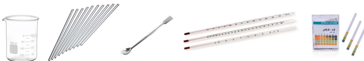
Слика 2. Лабораториска опрема која може да се користи за испитување на супстанците од шишињата (лабораториска чаша, стаклени стапчиња, шпатула за хемикалии, живин термометар, ленти од универзална индикаторска хартија).
