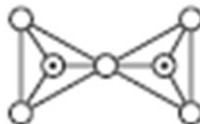
\text{Si}_2\text{O}_7^{6-} како во \text{Sc}_2\text{Si}_2\text{O}_7 (тортвеитит)
